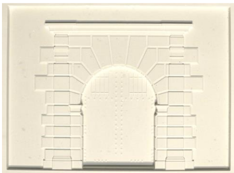
Fig. 8- Fresado de puerta con control numérico.
