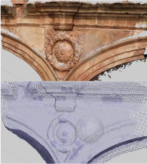
Fig. 3- Modelización textura y mallado fotogramétrico.
